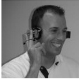
Abbildung 2. Der Benutzer von FreeDigiter bewegt einmal zwei Finger durch den Sensor am Ohr vorbei (Bewegung siehe Pfeil im Bild) für die Eingabe von Option '2'. Dabei ist keine visuelle Aufmerksamkeit für die Eingabe nötig. [10]
