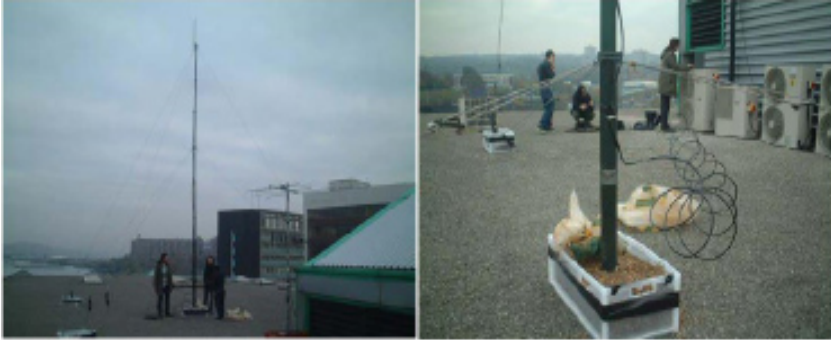
Abbildung 12. (links) Omni-direktionale Antenne, die zur Signalverstärkung des WLAN Netzes beim Spiel "Can You See Me Now?" dient. (rechts) Nahaufnahme der Antenne [10].
