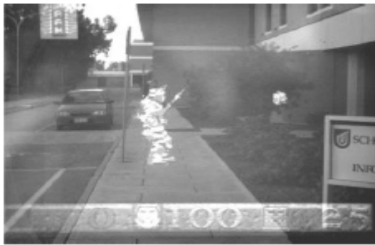
Abbildung 4. Ein Teilnehmer des Spieles "ARQuake" sieht einen anderen Teilnehmer auf seinem Head-Mounted-Display. Der Gegner wird virtuell in die reale Umgebung eingeblendet [11].
