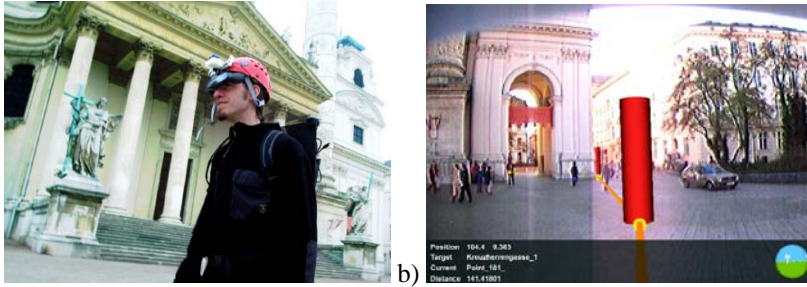
Abbildung 3 a) Die mobile und freihändige Ausrüstung. b) Die Anzeige im Navigationsmodus [2]
