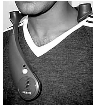
Abbildung 2. Voicebeam Neckset als Ein- und Ausgabe-Medium für das Nomadic Radio
