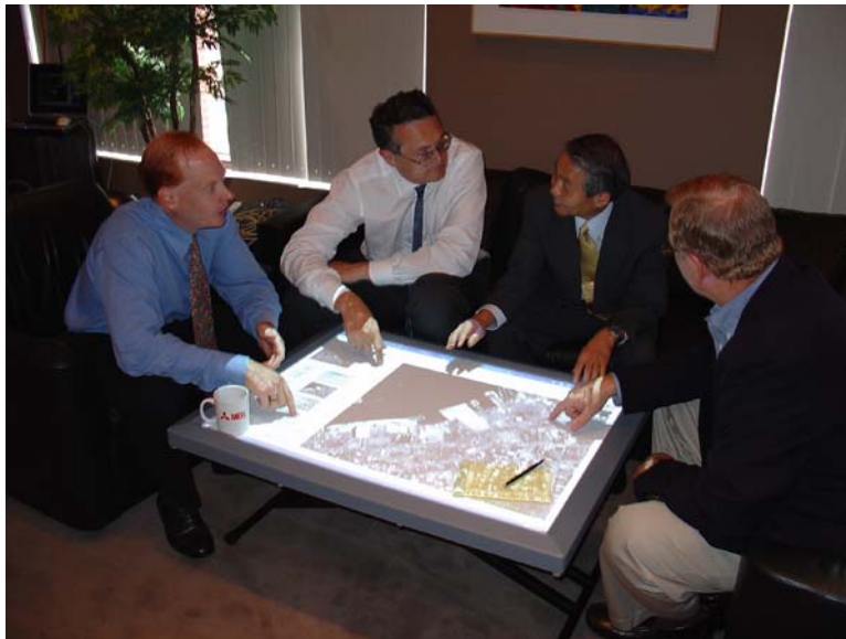
Abb. 2 MERL DiamondTouch ermöglicht die gleichzeitige Interaktion von bis zu vier Nutzern [18]
